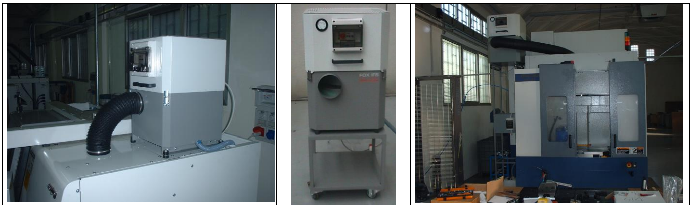
그림 8a) 공작기계의 인클로저 상에 직접 설치 b) 바퀴가 달린 카트 위에 설치 c) 수직 스탠드 위에 설치
