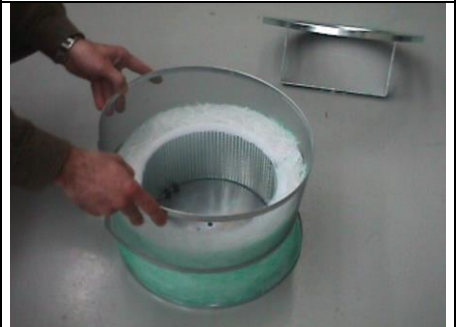
i) 금속 스크린을 다시 설치한다.
